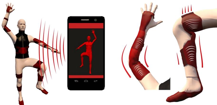
A la hora de generar correcciones Posturales, el accesorio transmite calor para poner los músculos en condiciones para luego con vibraciones e impulsos con electrodos fortalecer los músculos en la postura correcta.
