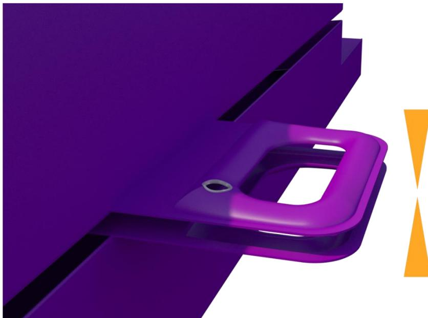
7. Luego se inyecta poliuretano a través de los ojales. Primero se realiza en las Asas, una vez endurecido el poliuretano, se inyecta el resto bloque en la posición de uso.
