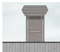
CHIMENEA DE MAMPOSTERI. DE LADRILLO COCIDO VISTO
