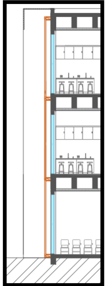
Imagen 15. Detalle de piel inserta en el edificio de investigación. Aproximación a la misma.
