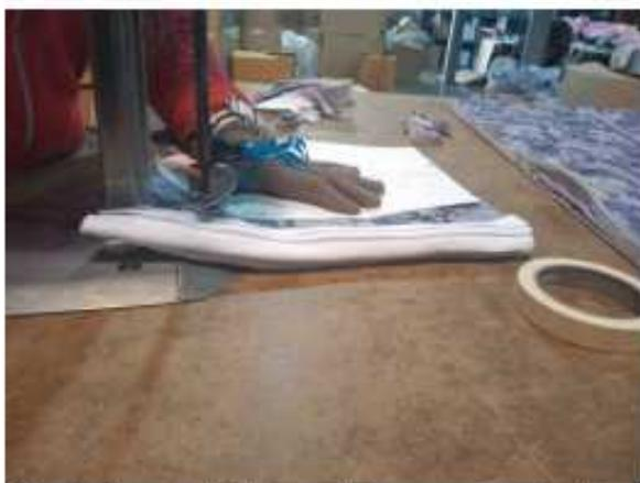
Cortadora eléctrica de mesa para tela. Puede cortar capas de tela encimadas hasta los 25cm de altura.
