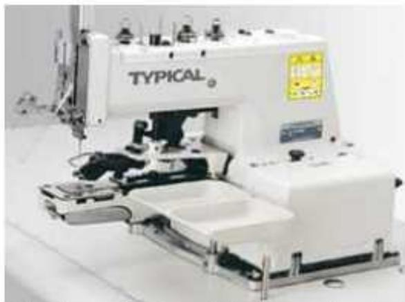
Maquina aplicadora de botones y tachas. Tiene una boca para agujerear y otra para aplicar las dos partes del botón. Se usa prenda por prenda.
