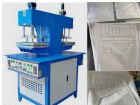
Texturizadora de tela, deforma las telas para marcar formas o patrones sin tener que usar un parche. Sirve para planchas de hasta 400x400mm.
