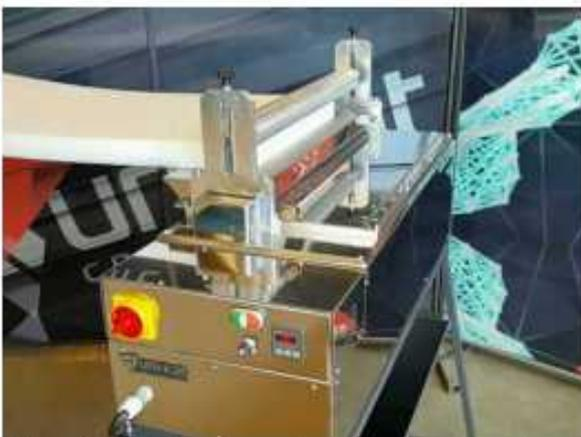
Maquina aplicadora de pegamento, el rodillo extiende el pegamento a lo largo de la superficie que pasa (altura maxima 78mm).
