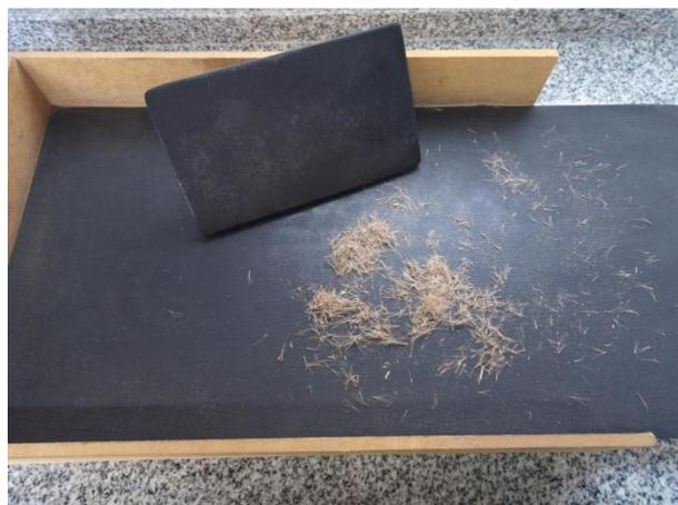
Figura 7: cajón y fratacho de madera forrados con goma de canaletas finas para escarificar las espiguillas de las especies en estudio.
