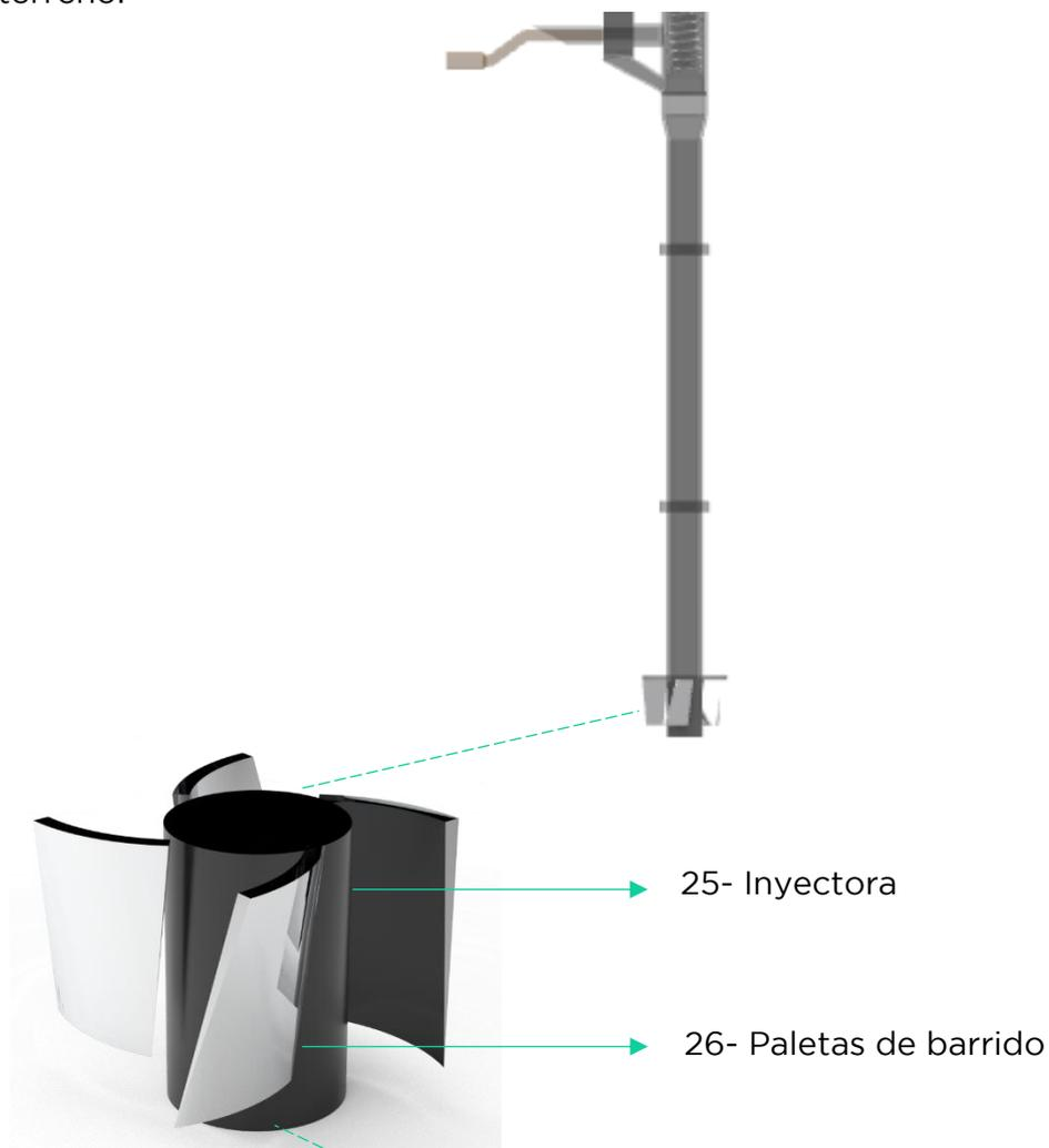
Forma cóncava de paletas para barrer la tierra cuando se rotan 90° y rellenar el orificio en el suelo,
