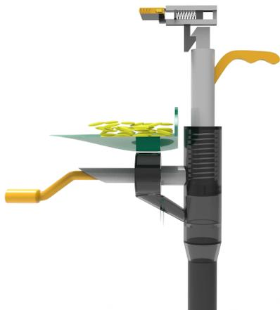
**2°** La manija externa (15) se gira 360°. La rueda dosificadora (10), deposita la semilla en el tubo conductor (16).
