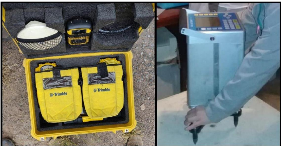
*Figura N°17: Instrumental, a la derecha gravímetro Scinterx cg5, y a la izquierda GPS tipo diferencial.*
