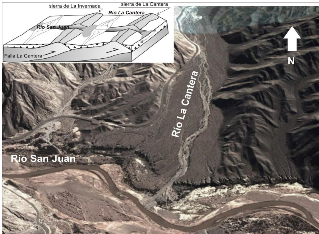
Figura 14. Imagen Google Earth en la que se observa el sistema colector conoide en la desembocadura del río La Cantera (de rumbo N-S) en el río San Juan (de rumbo O-E). Arriba a la izquierda se muestra un bosquejo esquemático de un sistema colector conoide desarrollado en una cuenca de tipo piggyback.
