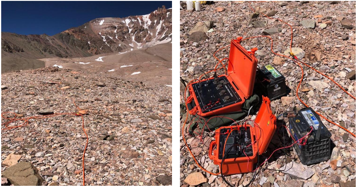
Figura 16. A la Izquierda: Adquisición del Perfil 4. A la derecha: Equipo multifuncional WJDJ-4 Digital DC Resistivity/IP Meter.
