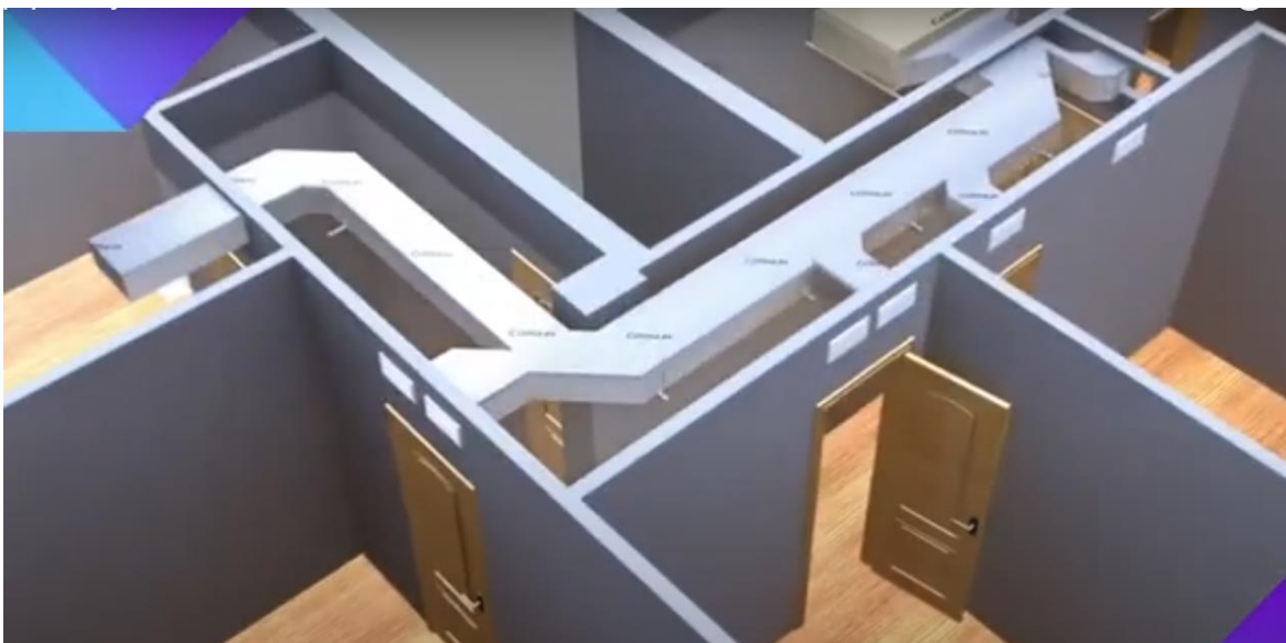
Sistema de canalizado de aire en diferentes ambientes, mediante bandejas de chapa galvanizada.
