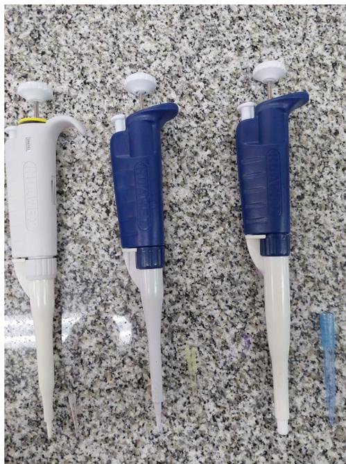
Figura 10: Micropipetas Huawei (volúmenes: 1000µl, 100µl y 10µl, de derecha a izquierda) utilizadas para la formulación de las diluciones.
