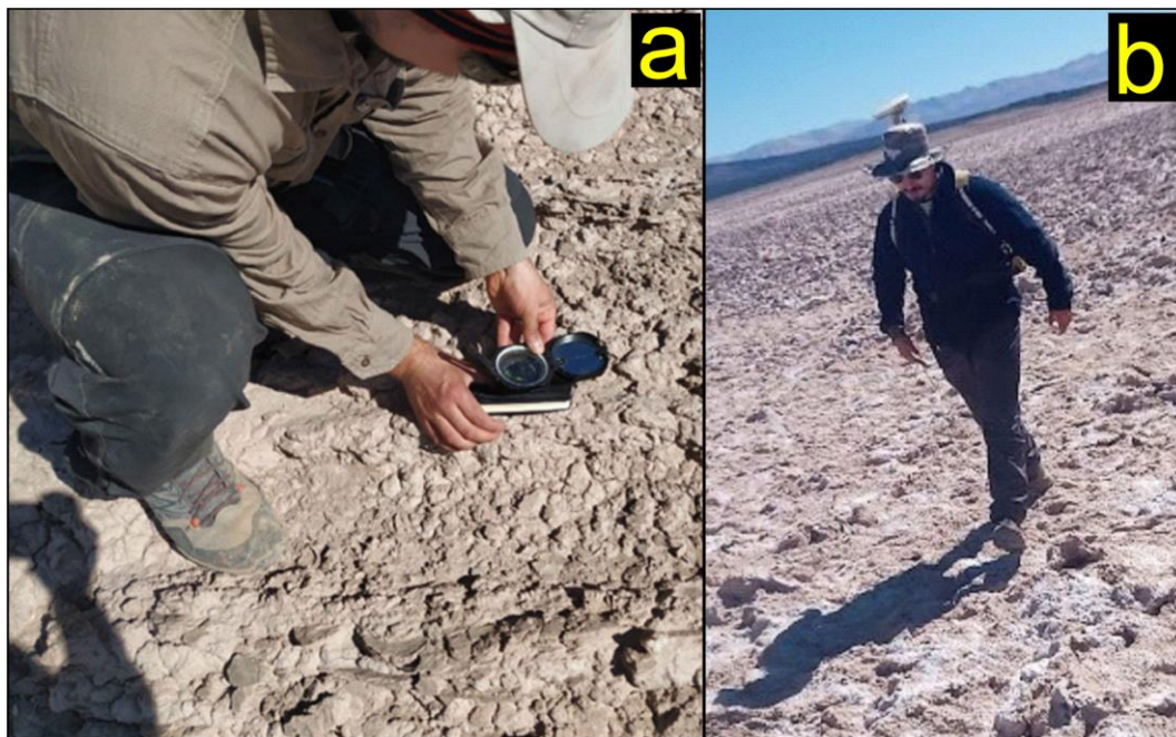
Figura 1.4: a) Foto tomada sobre el afloramiento neógeno en la localidad de Pismanta, en la cual puede observarse la medición del azimut y buzamiento de un estrato sedimentario con la brújula tipo Brunton. b) Foto de adquisición del magnetismo local con la metodología de walking mag .
