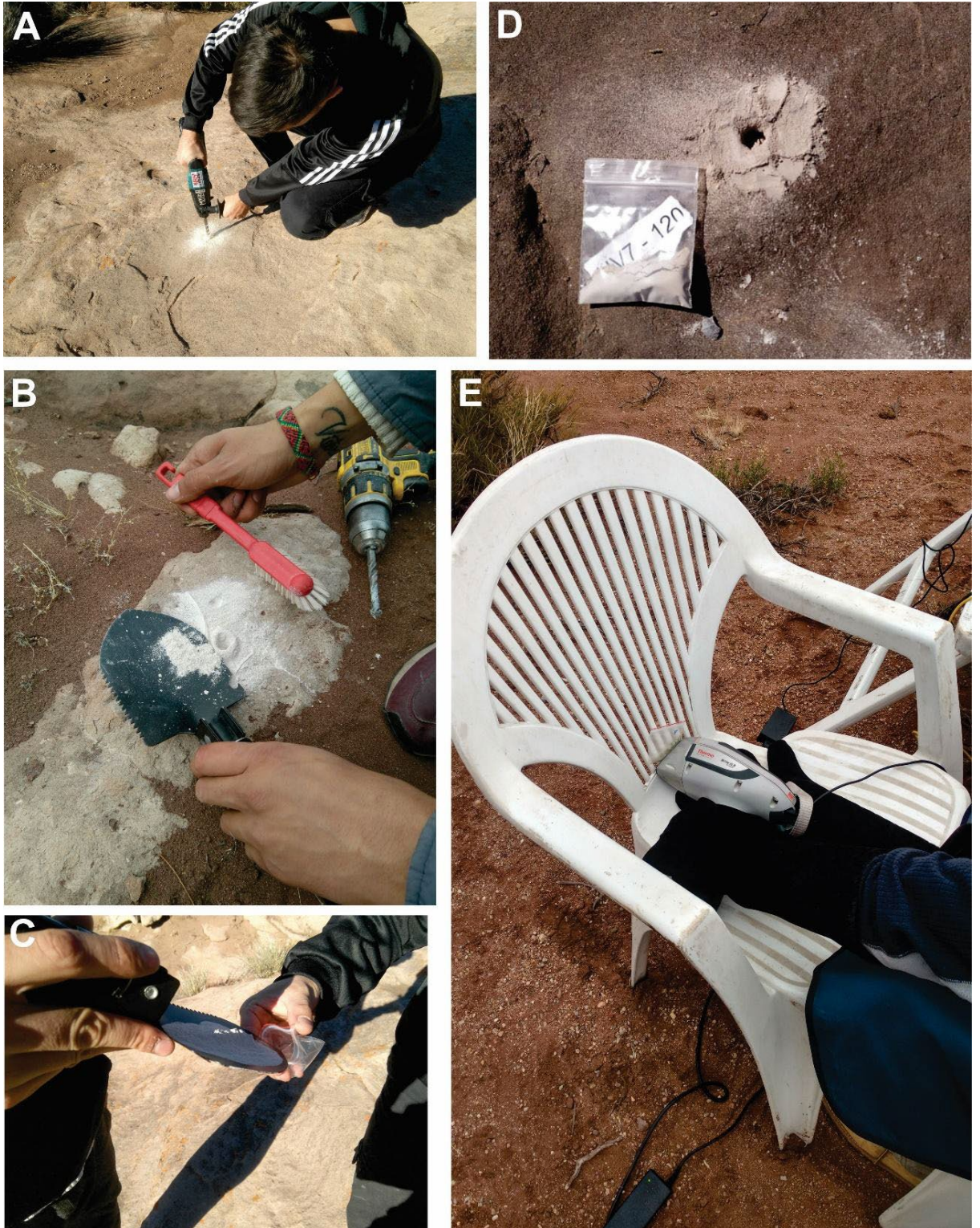
Fig.22: Metodología de muestreo de polvo de roca. A) Perforación en la roca utilizando un martillo roto-percutor. B) Extracción del polvo acumulado alrededor del hoyo. C) Guardado de la muestra en bolsa tipo ziploc de 5x5cm. D) Muestra ya extraída y etiquetada. E) Operario realizando análisis geoquímico in situ de una muestra de polvo de roca, con un analizador de elementos livianos Thermo Fisher Scientific modelo Niton XL3.
