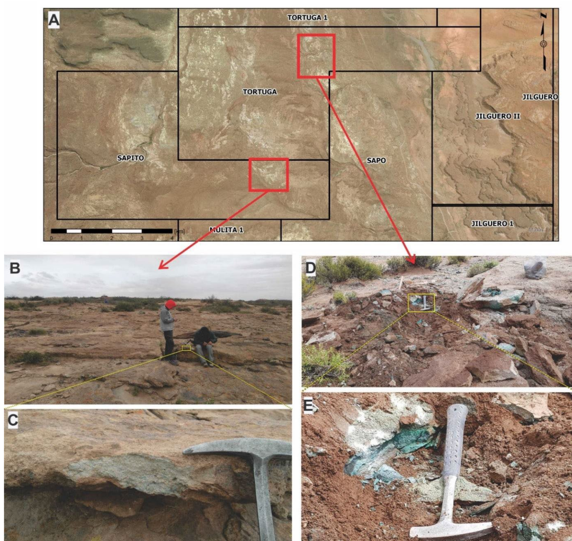
Fig.28: Mineralización en el sector Norte del Dorso De Los Chihuidos. A- Imagen satelital donde se señalan los sectores de mayor interés en la Zona Norte. B-C: Sector E del cateo Sapito, donde se observan extensos estratos con alteración tipo bleaching intensa y mineralización de Cu (crisocola) diseminada. D-E: Sector centro-norte del cateo Tortuga, donde se hallaron niveles con alta concentración de Cu (crisocola-brochantita) como cemento en areniscas.
