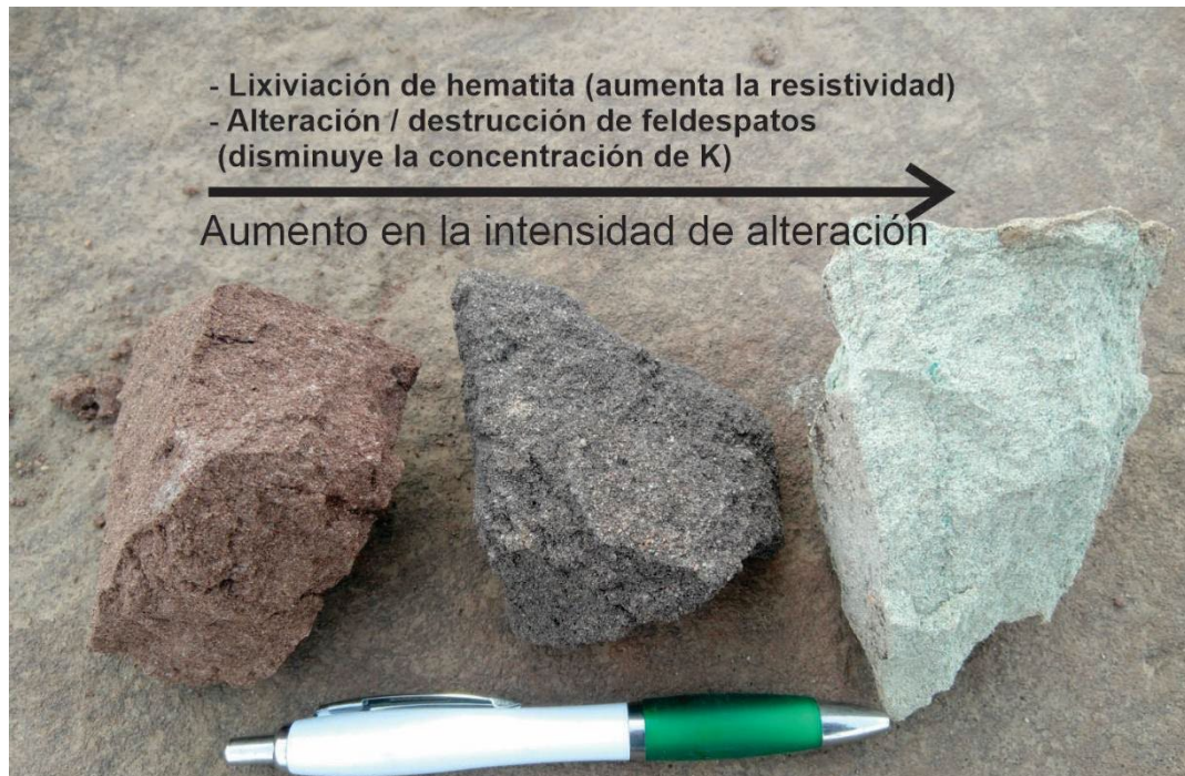
Fig.62: Muestras de mano de areniscas de la Fm. Huincul, en las que se observa un aumento en la intensidad de la alteración de izquierda a derecha, con la consiguiente disminución en el contenido de hematita (por lixiviación) y destrucción de los feldespatos (que se alteran a esmectita). El resultado es un aumento en la resistividad y una disminución en la concentración de K de la roca, rasgos que pueden ser detectados por métodos geofísicos.
