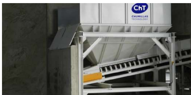
Ilustración 22. Tolvas de recepción para el almacenamiento temporal de ingredientes a granel.
