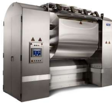
Ilustración 25. Amasadoras de alta velocidad para la producción eficiente de la masa.
