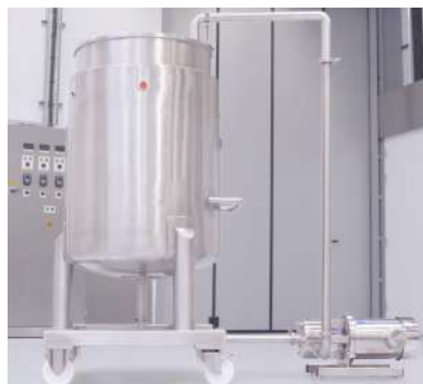
Ilustración 17. Agitadores automáticos con control de temperatura.
