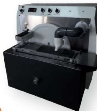
Ilustración 32. Tanques de baño de chocolate para sumergir los alfajores en cobertura de chocolate.
