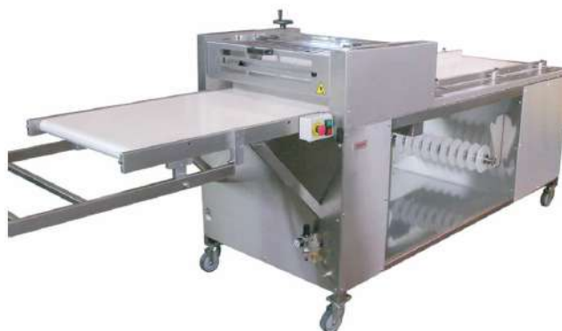
Ilustración 28. Cortadoras automáticas con moldes intercambiables para producir formas individuales de alfajores.
