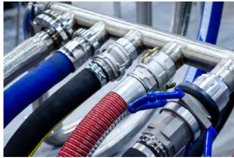
Ilustración 20. Tuberías y mangueras sanitarias.
