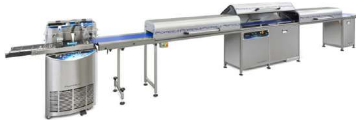
Ilustración 33. Mesas de enfriamiento para garantizar que el relleno y la cobertura adquieran la consistencia adecuada.
