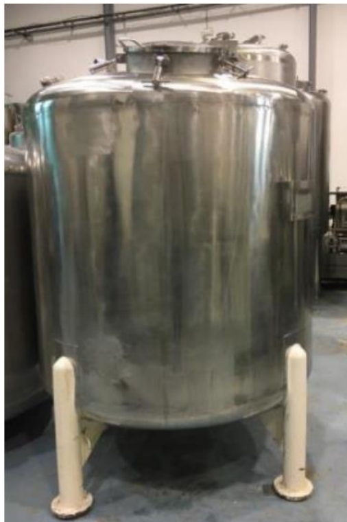
Figura 5.1 Tanque almacenamiento solución NaOH.
