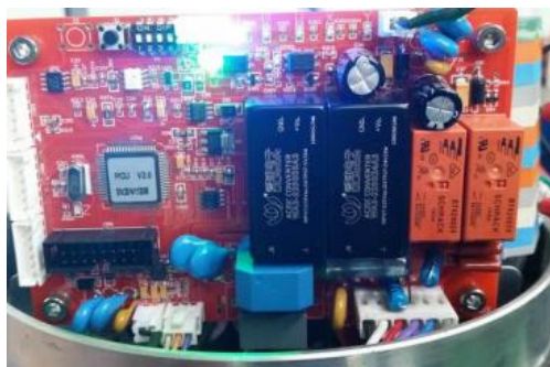
Figura 6.21: Posicionador Eléctrico – Genebre
