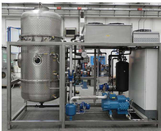
Fig 5.21 Evaporador al vacío de circulación natural.
