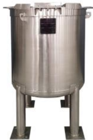
Figura 5.6 Tanque agitado de pretratamiento.
