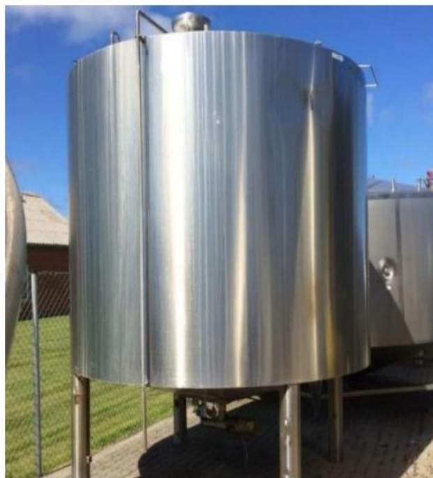
Figura 5.2 Tanque almacenamiento glicerol crudo.
