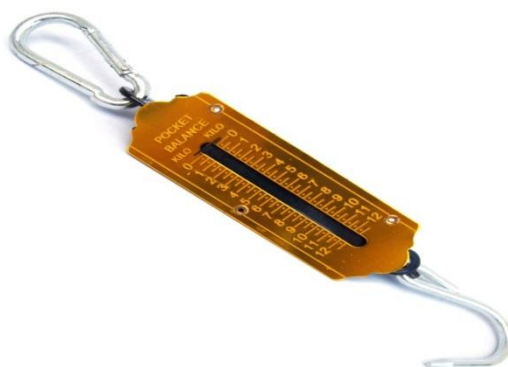
Figura 6: Dinamómetro utilizado para realizar el pesaje de los residuos sólidos.
