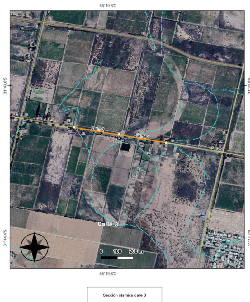
Figura 99: Ubicación de la sección sísmica calle 3 en el departamento 25 de Mayo. La imagen señala de color naranja el tendido sísmico y los dos perfiles construidos en dirección (oeste-este). De color celeste se encuentran mapeados los paleocauces que atraviesan esta zona.
