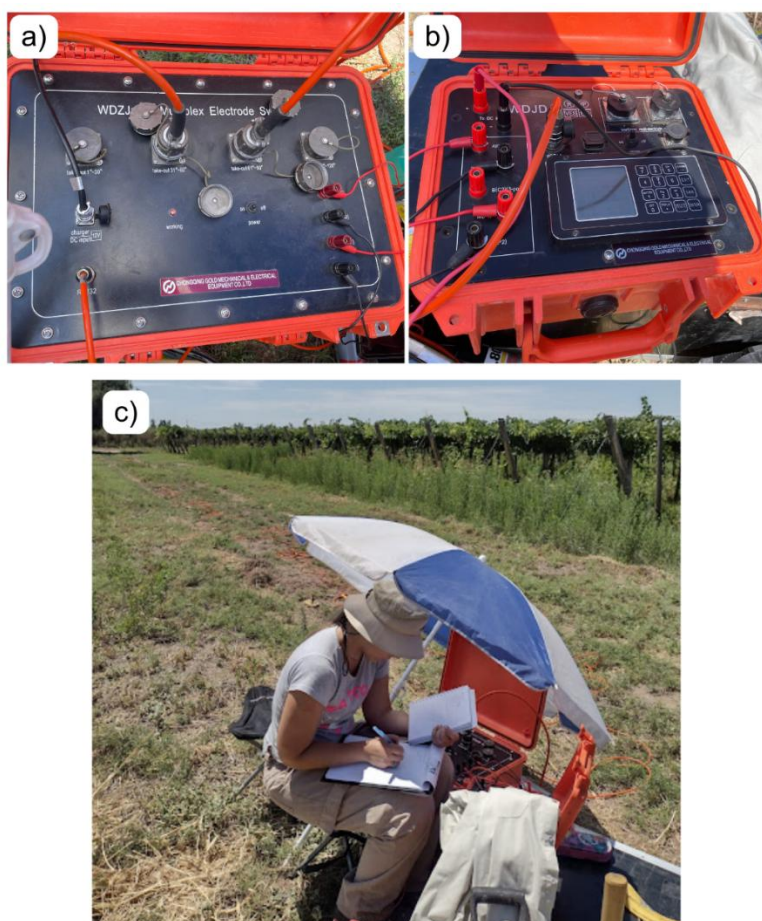
Figura 84: Componentes del sistema WDJ-4 utilizados en la campaña: a) Módulo multiplexor de 120 canales del equipo de tomografía eléctrica WDJ-4, encargado de la conmutación automática de los electrodos durante la adquisición de datos. b) Unidad principal del resistivímetro WDJ-4 utilizada para la generación de corriente,
