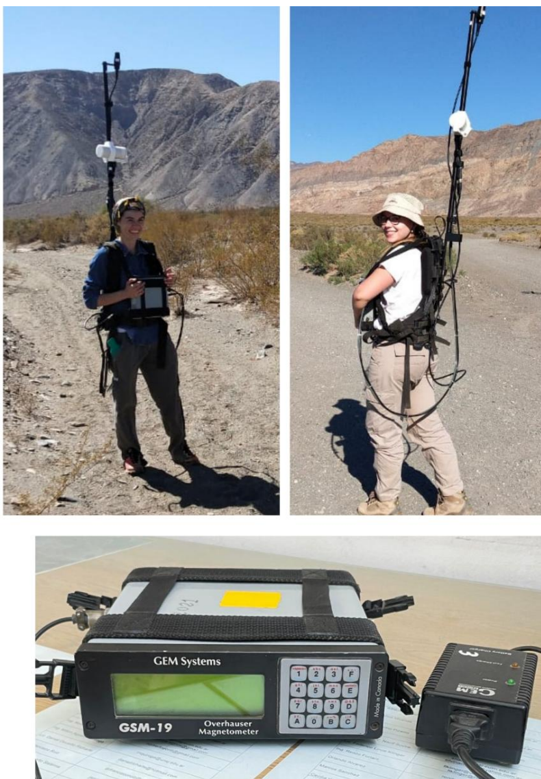
Figura 59: Magnetómetro GEM Systems Overhauser. Las imágenes superiores muestran el uso del equipo durante las mediciones de campo, donde se observa al operador transportando la mochila que sostiene la CPU y la antena del magnetómetro. En la imagen inferior se presenta un acercamiento (zoom) de la unidad central (CPU) del magnetómetro de campo total GEM Systems Overhauser GSM-19 V7.
