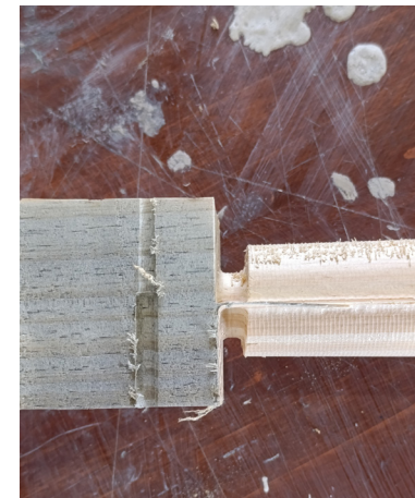
Prototipo escala 1:1 fresado CNC, fabricado en Protolab, FAUD. Fotografías propias.
