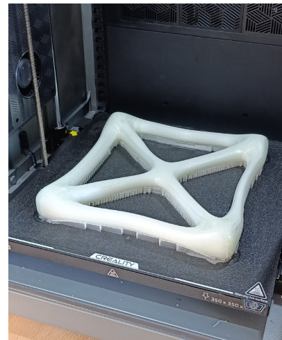
Prototipo escala 1:1 Impresión 3D FDM fabricado en Protolab, FAUD. Fotografías propias.
