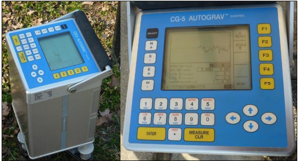
Figura 36: Gravímetro Scintrex Autograv CG-5, el rango de operación en todo el mundo es de (8,000 mGal sin reinicio) tiene una resolución estándar de 1 microGal con una desviación estándar de <5 \mu Gals. Es el medidor de gravedad más rápido y portable.
