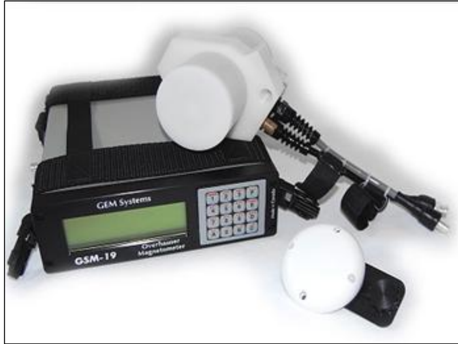
Figura 37: Magnetómetro de precesión protónica, utilizados para medir las variaciones en el campo magnético de la Tierra.
