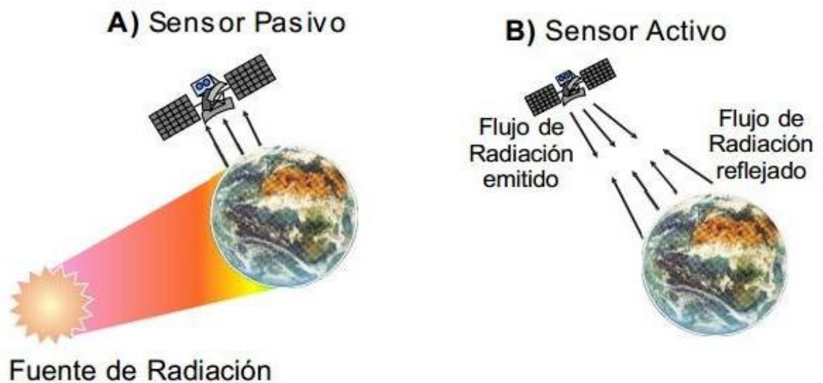
Figura 17: Tipos de sensores, de acuerdo con el origen de la fuente de radiación; A) Sensor pasivo y B) Sensor activo (Pérez, 2007).
