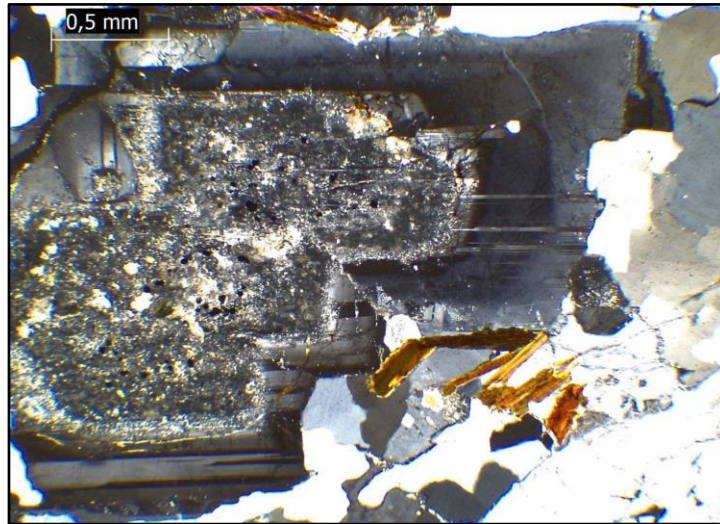
Fotomicrografía N°15 : Cristal de plagioclasa zonado y maclado, con una fuerte alteración en el interior a minerales arcillosos, sericita y la presencia de opacos -NX(4x)-.
