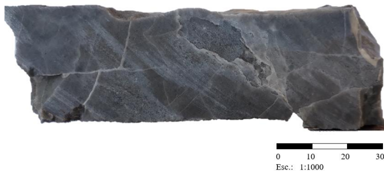
Fotografía N° 1: Caliza clara tipo grainstone según la clasificación de Dunham (1962)
