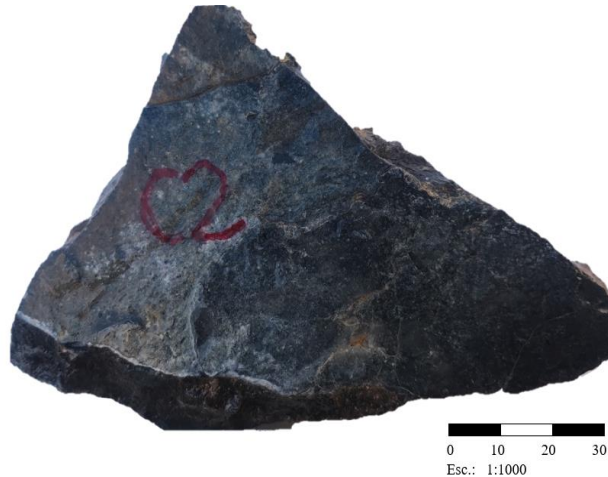
Fotografía N° 2: Caliza oscura tipo wackestone según la clasificación de Dunham (1962).
