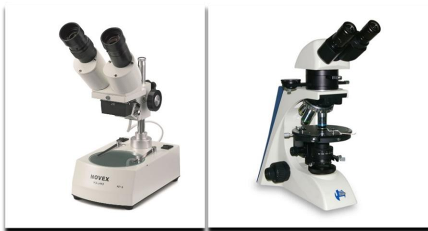
Figura 1.6: A la izquierda se observa la lupa de gran aumento utilizada para observar las características macroscópicas de las muestras y a la derecha el microscopio óptico de polarización Biotraza calcográfico con el que se realizó el reconocimiento de las características microscópicas de cada muestra.
