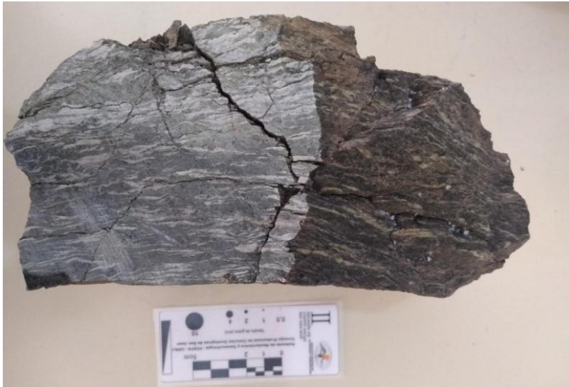
Figura 3.11: Muestra de mano de milonita de anfibolita, con marcado estiramiento de minerales formando bandas leucocráticas y melanocráticas. Además se puede observar porfiroclastos de Pl con formas sigmoidales.
