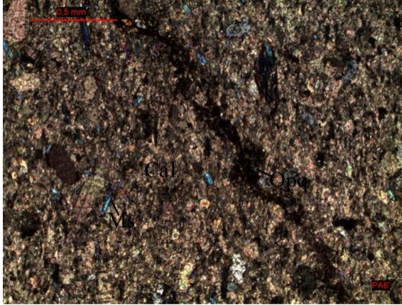
Figura 3.14: Textura granoblástica compuesta por calcita (Cal), algunas folias de Moscovita Ms. Fractura rellena por opacos (Op).
