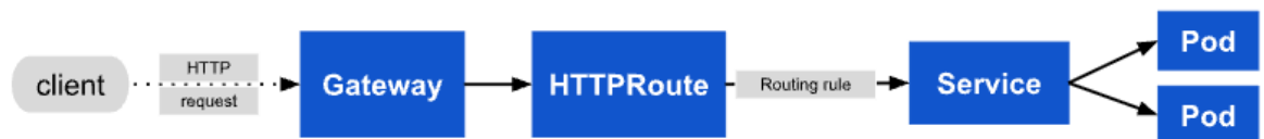
Figura 5: Diagrama de flujo entre componentes Gateway. Reproducido de [22]
