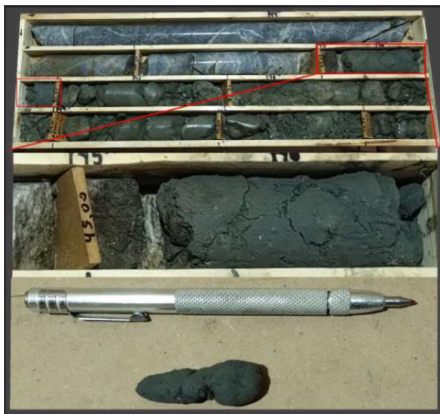
En la Figura 3.64: Se observa a los 45 metros el contacto entre las calizas y vaques con lutitas, en sondeo P4-23. Se muestra el contacto de arcillas verdes oscuras a la profundidad entre los 45 a los 46.20 (zona de cizalla) (Imagen obtenida del informe de la UTE Tambolar).
