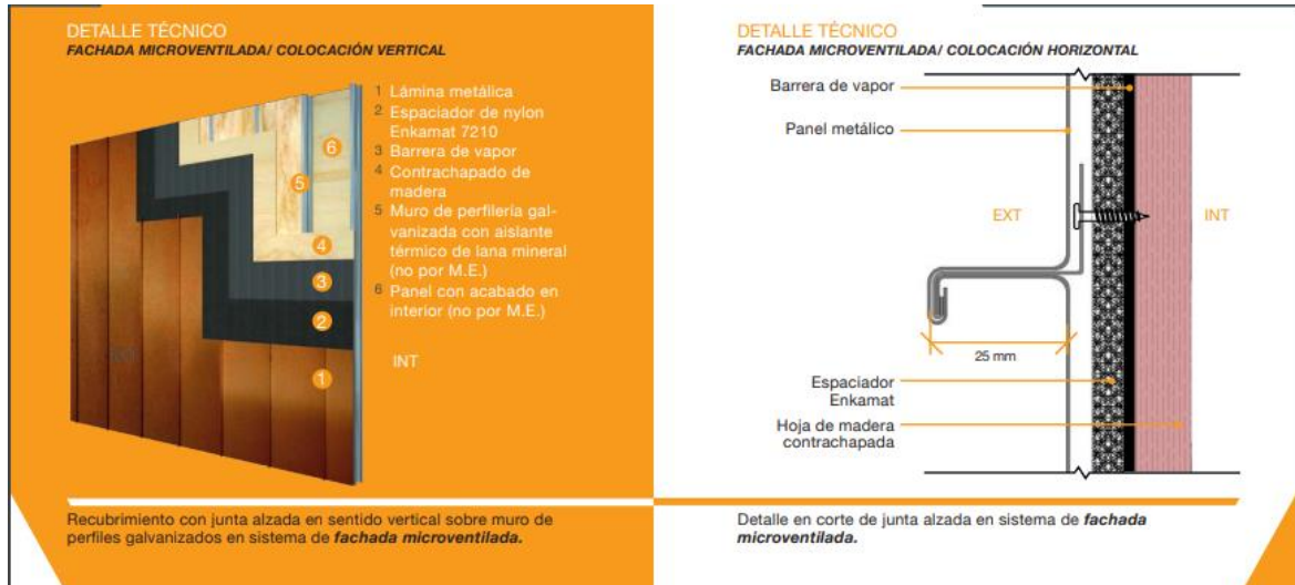
Detalles Técnicos. Sistema de paneles flatlock. Catalogo.
