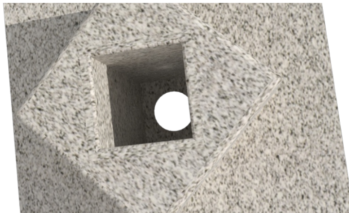
Pasaje de cableado y sustento para la TRABA SOPORTE.
