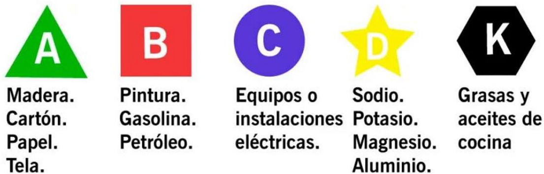
Figure 34. Clasificación de extintores.
