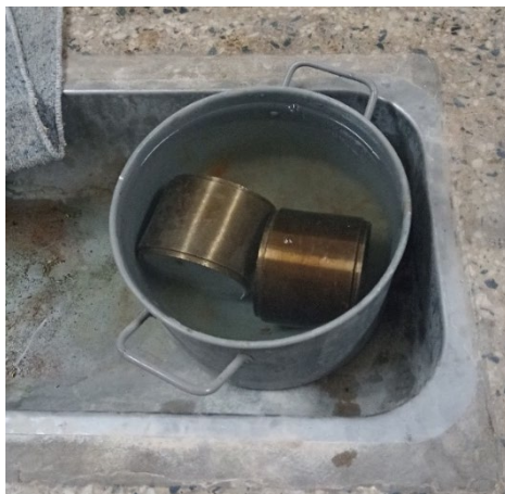
Enfriado de probetas en agua para desmolde.
