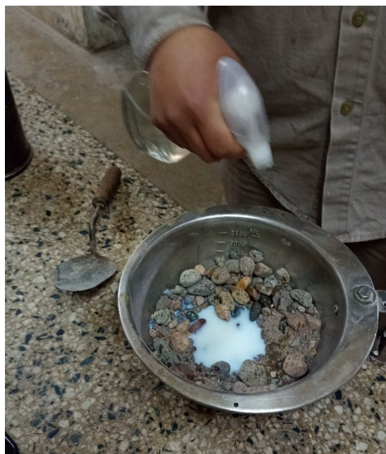
Incorporación de agua mediante rociador.
