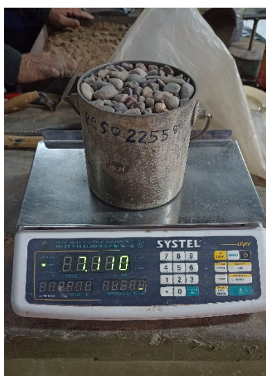
Pesaje total grava compactada.
