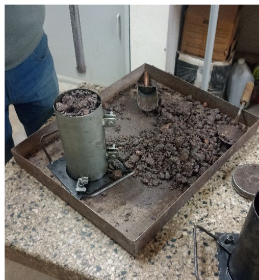
Remoldeo con adición de ligante.
