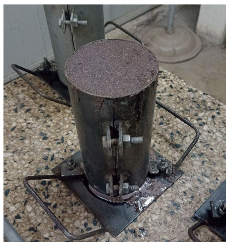
Medición de asentamiento, falla por corte.
