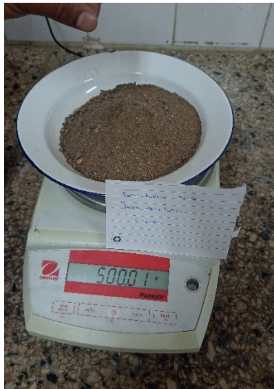
Arena en condición SSS para ingresar a estufa.
