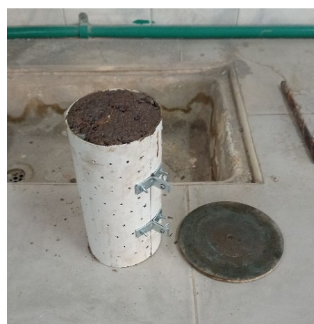
A 24hs de moldeo, giro y semi fraguado.
