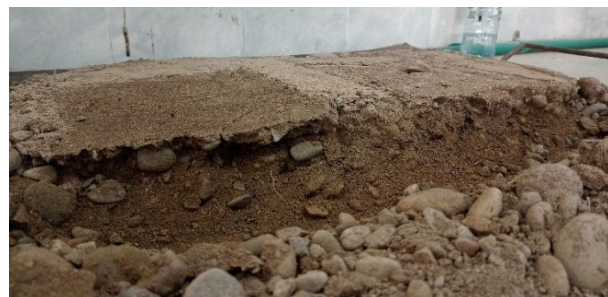
Corte para observar penetración.
