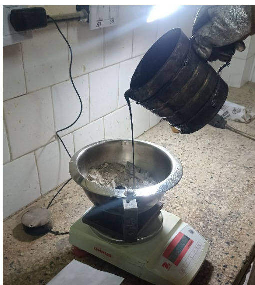
Vertido de asfalto en recipiente con agregados, se hace llegar el pesaje a los 1200grs.
