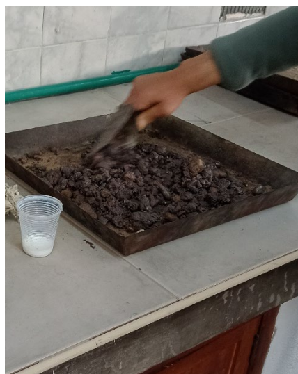
Mezclado de material, con incorporación gradual de ligante.
