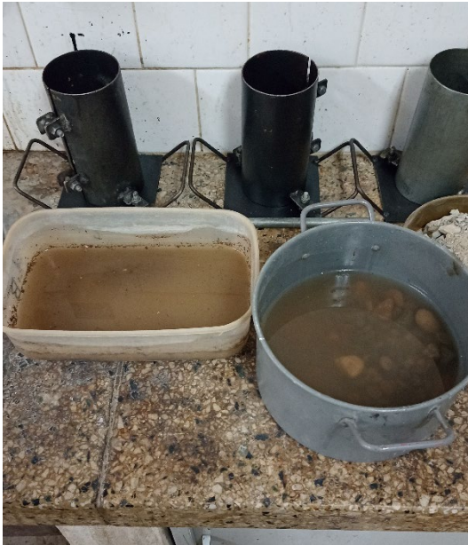
Arena y Grava en proceso de saturación.
