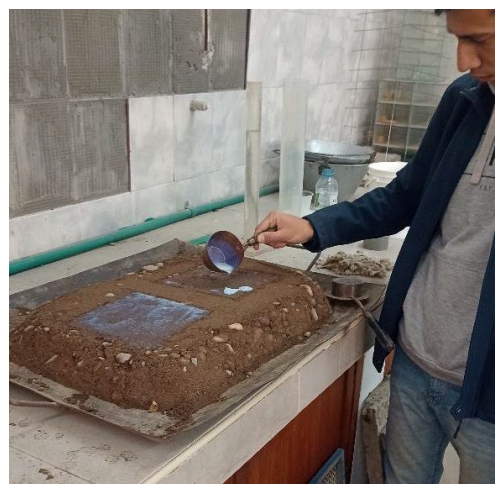
Colocación de emulsión rebajada.
