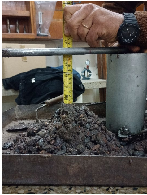
Medición de asentamiento. 10cm.
