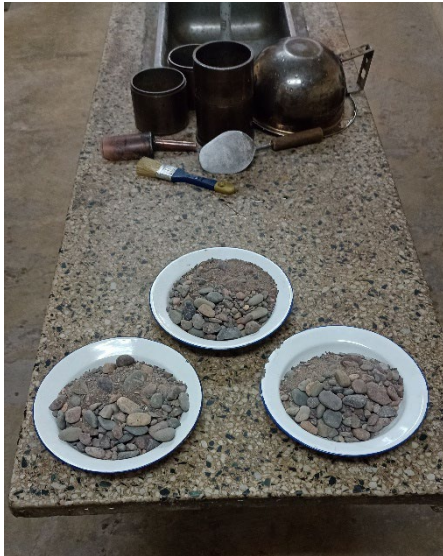
Muestras en proporciones de arena y grava según mezcla, peso 1200gr.
