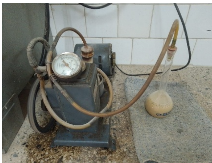
Bomba de vacío extrayendo el aire.
