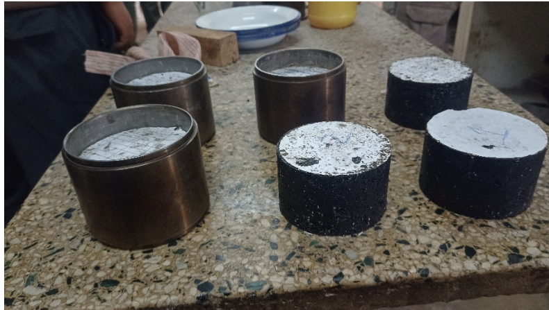
Probetas de asfalto desmoldadas y probetas de “Liganus” recién terminadas con su molde.
