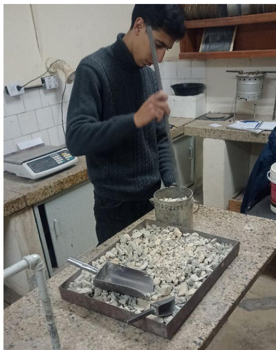
Compactado con varilla, segunda capa.
