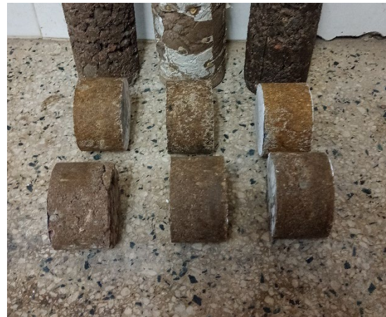
Muestras previas a ensayo, se puede observar la diferencia de color. Superiores triturado e inferiores canto rodado.
