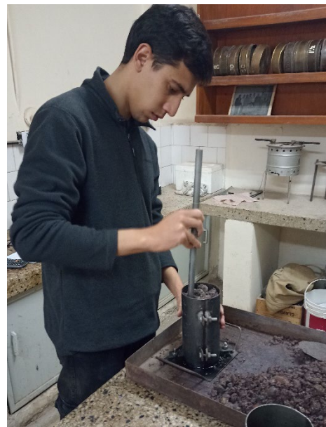
Compactado de tercera capa.
