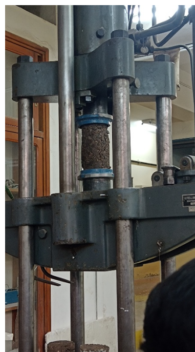
Probeta llegada a la rotura.
