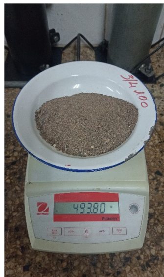
Arena en condición seca, retirada de estufa.
