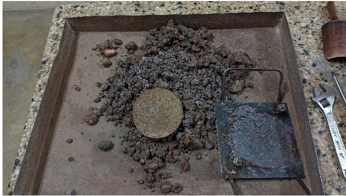
Se observa la “tapa” endurecida, el resto del material sin fragüe y en la base la exudación agua+ligante seca.
