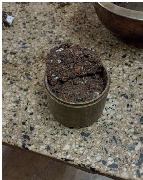
Estado de la probeta compactada luego del fallo.
