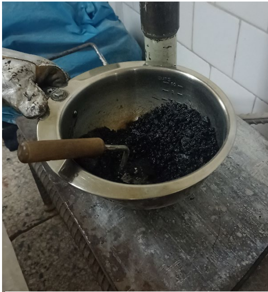
Mezclado de concreto listo para moldeo.
