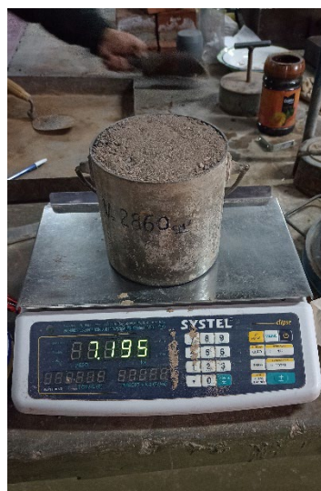
Pesaje total arena compactada.
