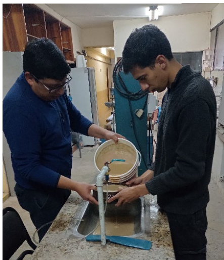
Balde con finos del triturado sumergidos, volcando en tamiz #200.
