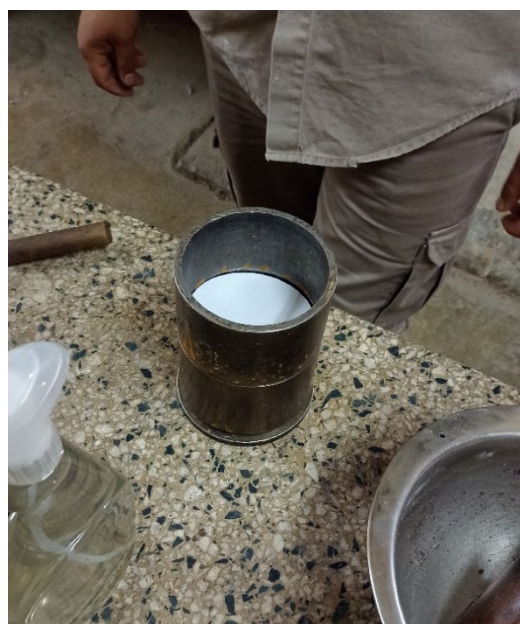
Colocado de muestra en molde junto con papel de filtro y collarín.
