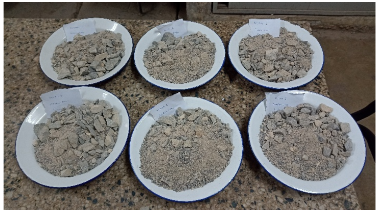
Muestras iguales listas para 6 probetas, pesadas y rotuladas.
