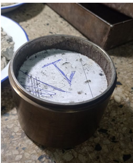
Probeta 1, marca de exudación en el molde.
