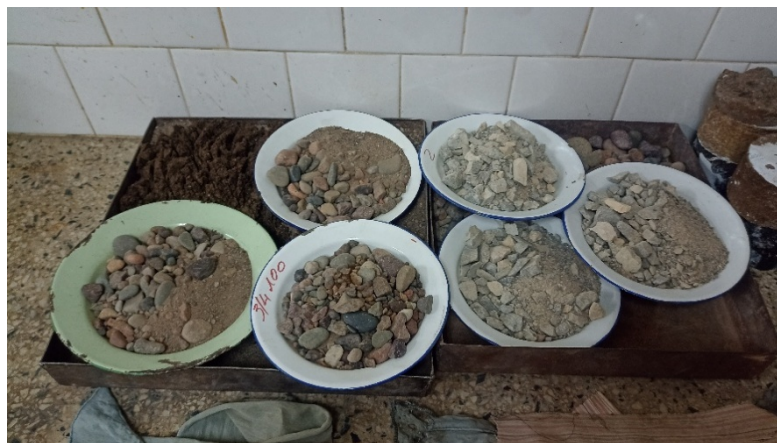
Muestras separadas de ambos agregados.
