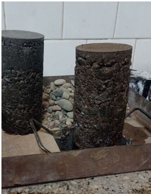
Probeta “Liganus” desmoldada (der), se observa ladeo en la parte superior.
