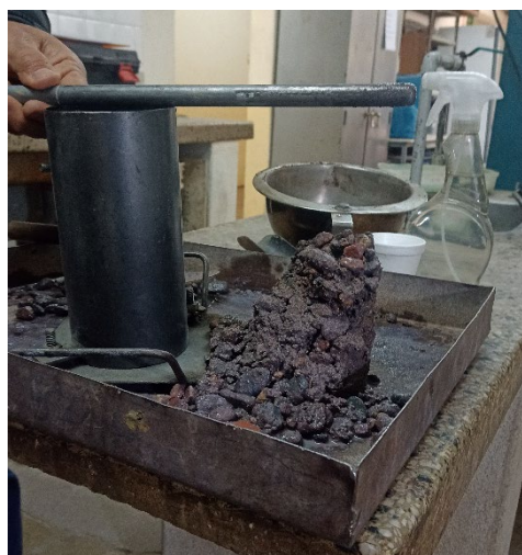
Medición de asentamiento, falla por corte.
