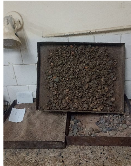
Bandeja en posición vertical, demuestra material adherido.
