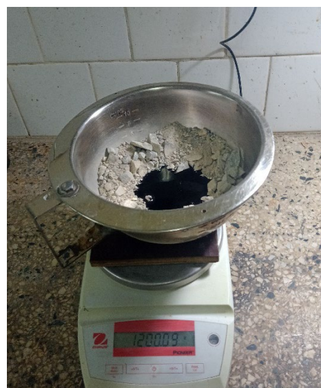
Recipiente semiesférico con grava, arena y asfalto listo para mezclado.
