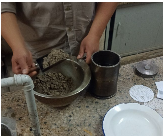
Mezclado finalizado y llenado de molde con collarín.
