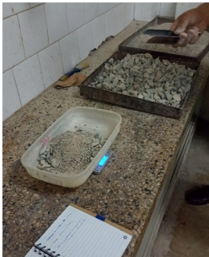
Pesaje de Grava y Arena para una probeta.
