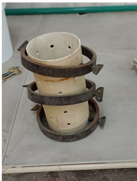
Molde perforado 1 con sujeciones.
