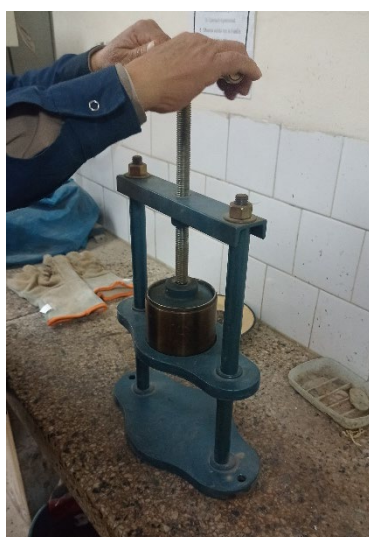
Desmolde de probeta con extractor.
