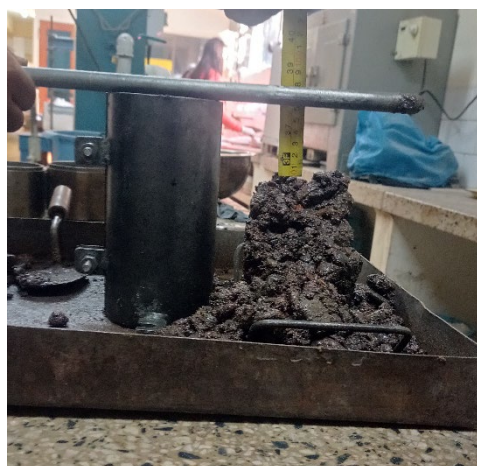
Medición de asentamiento. 6cm.
