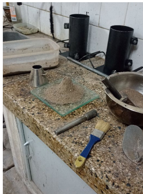
Ensayo de condición SSS tronco-cono, pisón, pincel y vidrio.
