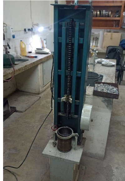
Pedestal de compactación con molde posicionado.
