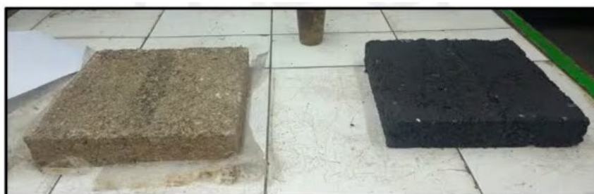
Probeta de “Liganus” (izq) y Probeta de Asfalto (der).
