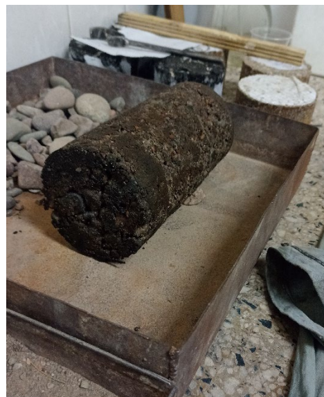
A 24hs de desmolde ya no poseía brillo de humedad y pudo manipularse para medir.
