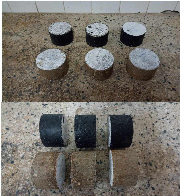
Probetas desmoldadas a las 24hs.
