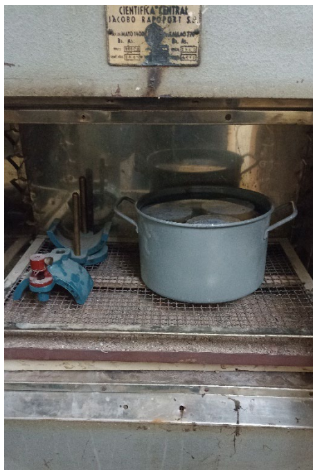
Probetas y elementos de sujeción en estufa.
