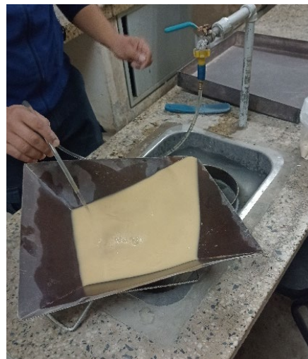
Bandeja de lavado con retenido #200 de grava de triturado.
