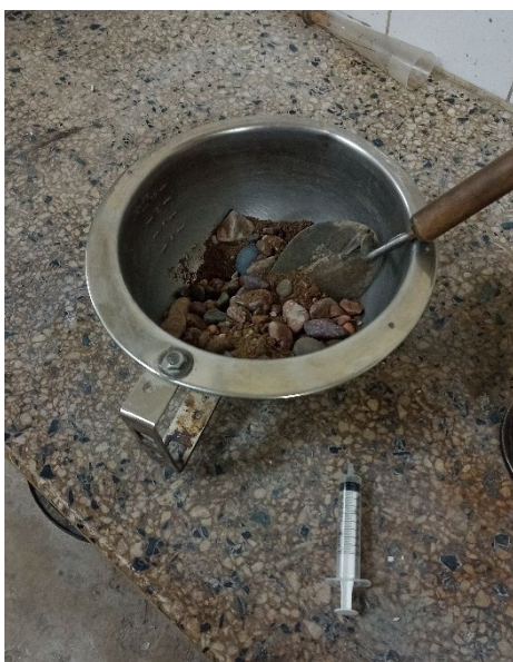
Árido humectado con agua de absorción.
