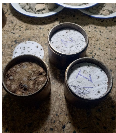
Probetas ejecutadas con canto rodado, se observa sequedad de la 3 y el despegue del papel.
