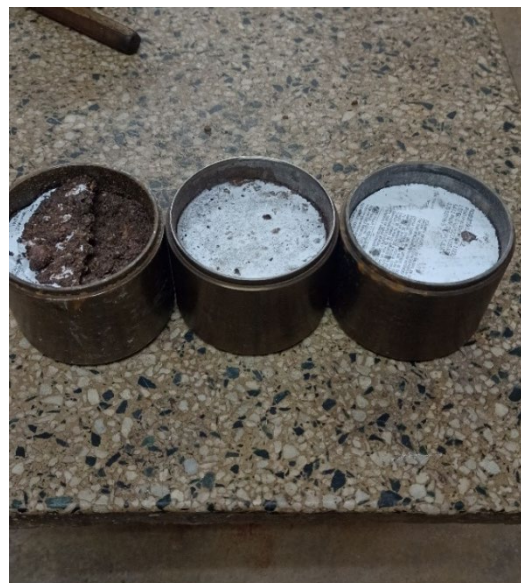
Probetas moldeadas, se observa en la del medio la marca de exceso de agua en el interior del molde.
