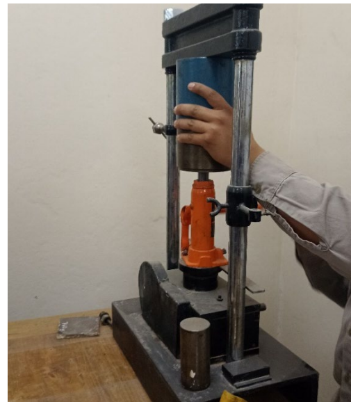
Marco rígido con gato hidráulico en proceso de desmolde.
