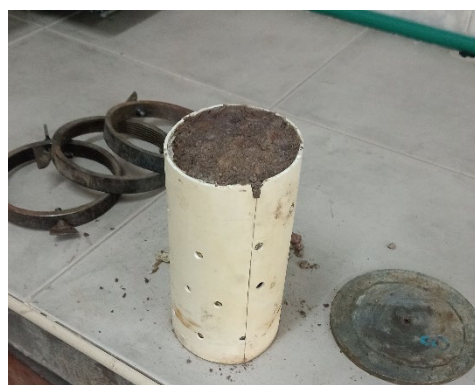
Girado de probeta, material fresco. Se observa base perforada.
