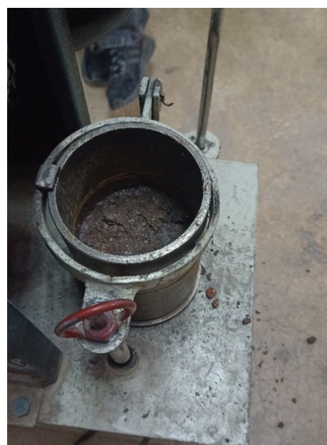
Falla de probeta, capa no adherida y despegada junto con papel de filtro.
