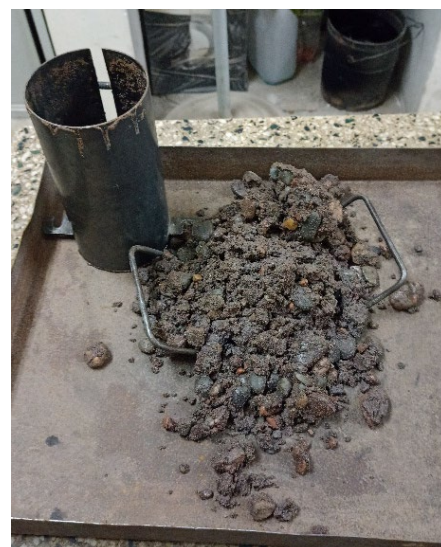
Resultado del desmolde, deslizamiento de cilindro.
