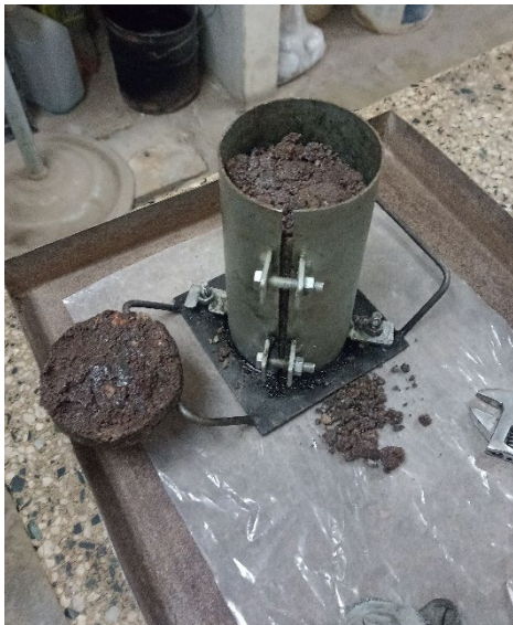
Separación de la formada tapa respecto de la probeta.
