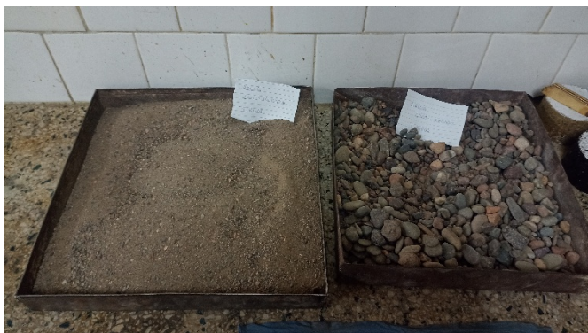
Canto Rodado para Probetas sometidas a Compresión. Arena y Grava.
