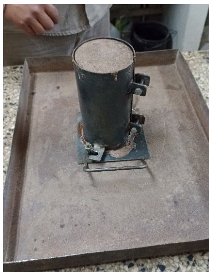
Molde con tuercas aflojadas y base rotada.
