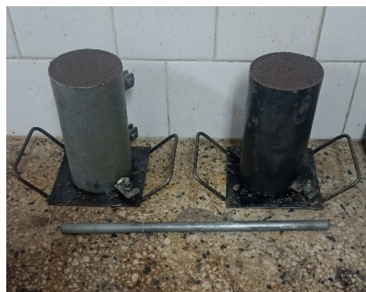
Las dos probetas remoldeadas con más ligante.
