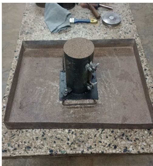
Estado de probeta antes de desmolde.
