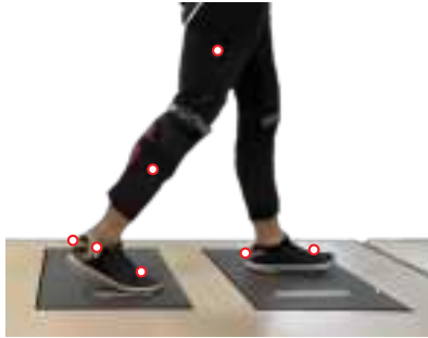
Figura 4.6: Montaje experimental utilizado para el registro de variables cinemáticas y cinéticas del tobillo en marcha. Los puntos rojos representan los marcadores colocados en el participante bajo el modelo Plug-in-Gait
