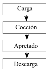
Figura 2.12: Pasos u operaciones básicas que se ejecutan durante la segunda y tercera etapa de la cristalización.
