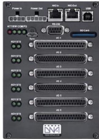
Figura 3.3: Sistema adquirente de datos Ueism 600 – 1G Cubo.
